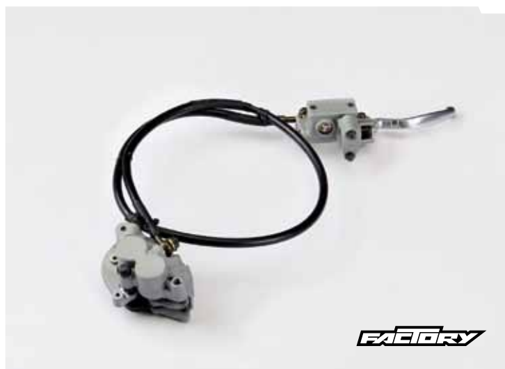
KIT FREIN AVANT FACTORY (LEVIER RÉGLABLE) 2016-26 FACTORY FRONT BRAKE KIT (AJUSTABLE LEVER) 2016-26
