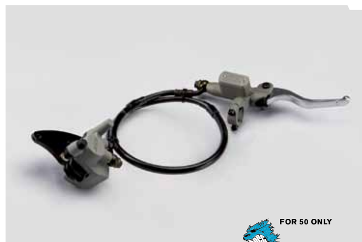
KIT FREIN AVANT HYDRAULIQUE YCF 50 2020-26 (ADAPTABLE SUR LES YCF 50 2012-2019)
